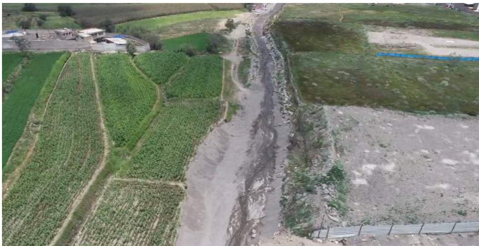
IMAGEN 02: SE OBSERVA EL TRAMO COLMATADO AGUAS ABAJO CON CULTIVOS EN AMBAS MARGENES SIN NINGUN TIPO DE ESTRUCTURAS SIENDO AFLUENTE DE LA QUEBRADA DE LA QUEBRADA POZO NEGRO LA UNION DE QUEBRADAS
