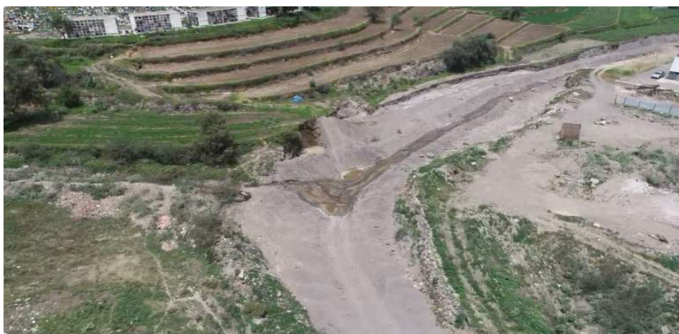
IMAGEN 01: SE OBSERVA EL TRAMO COLMATADO SIN NINGUN TIPO DE ESTRUCTURA DONDE SE UNE EL AFLUENTE ENTRE LA QUEBRADA S/N Y LA QUEBRADA POZO NEGRO
